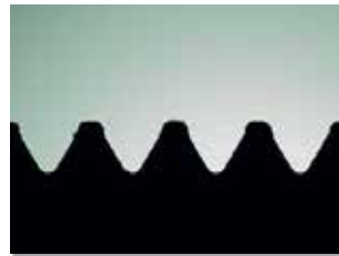
Профиль резьбы в проходящем свете
