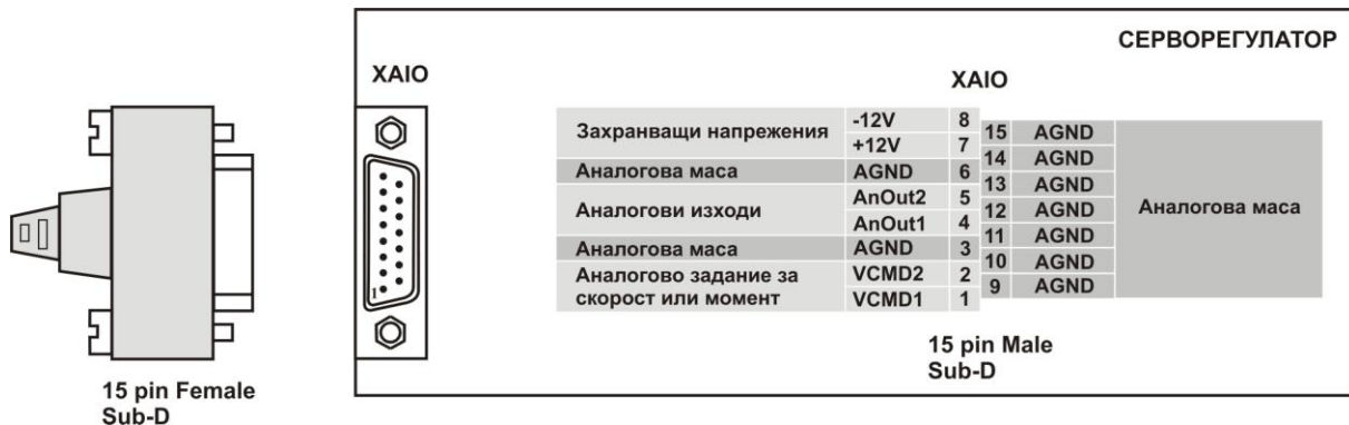
Рис. 4.15. Разъем Аналоговые входы и выходы, XAIO.
