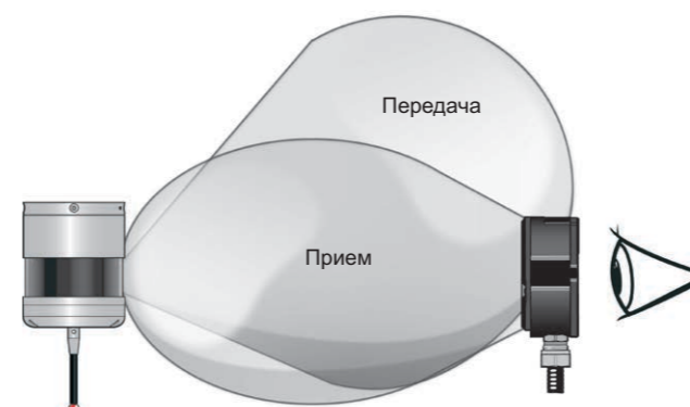
Совмещенные картины, получаемые от датчиков (передатчиков) и приемника, между которыми существует прямая видимость.
