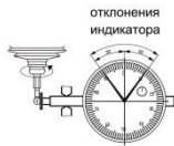
Рис. 2.2. Регулировка тестового индикатора.
