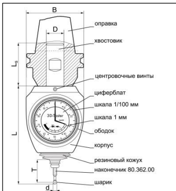
Рис. 1. Описание конструкции, габариты.
