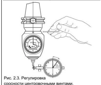
Рис. 2.3. Регулировка соосности центровочными винтами.
