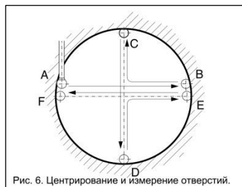
Рис. 6. Центрирование и измерение отверстий.
