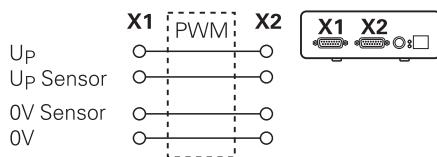
Ejemplo 2 – El equipo alimenta al sistema de medición a través de X1:
