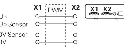
Příklad 2 – Přístroj napájí měřidlo přes X1:
