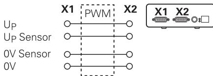
Esempio 2 – L'apparecchiatura alimenta l'encoder tramite X1:
