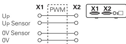
Exemple 2 – L'appareil alimente le système de mesure via X1 :
