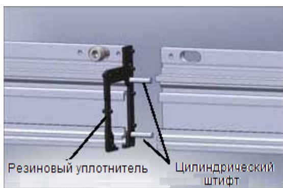
Рис. 5.2 Соединение корпусов Рис. 5.3 Коррекция поверхности
