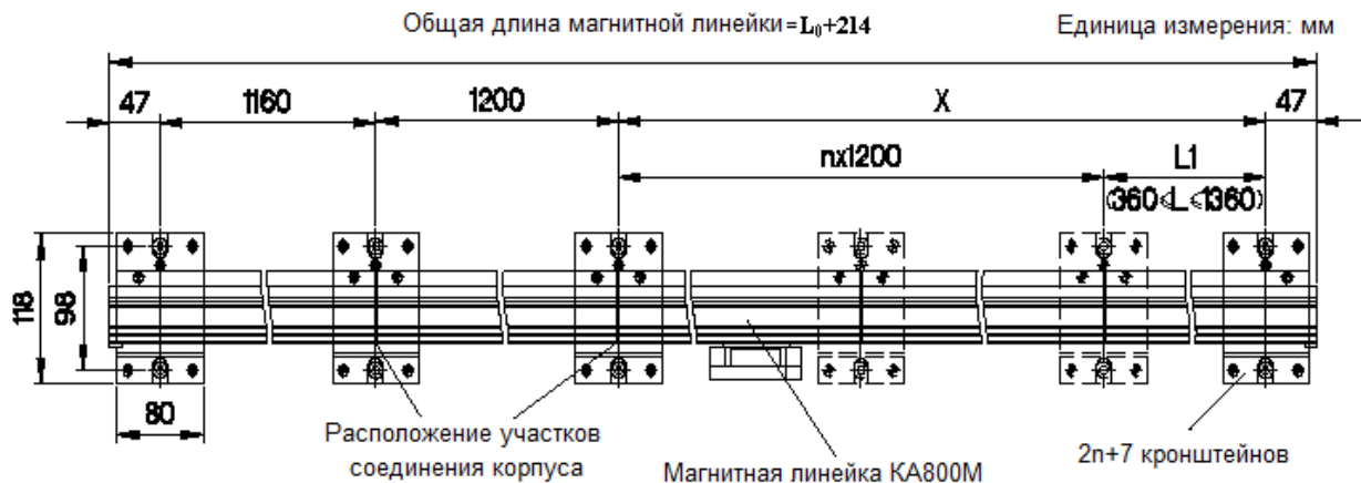
Рис. 5.18 Схема соединения корпуса измерительной линейки и кронштейнов с размерами.
