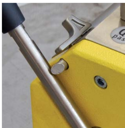
Оператор всегда видит устройство блокировки, что позволяет держать процесс под контролем
