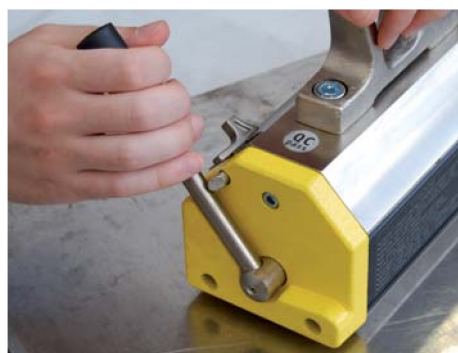
Активация устройства плавным движением рычага без рывка
