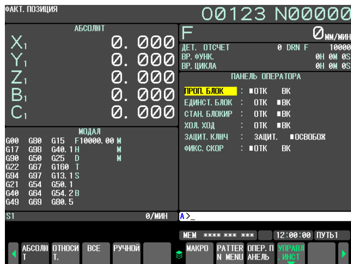
Рис. 12.3.8 (с) Страница 2 окна программной панели оператора (дисплей 10,4 дюйма)
