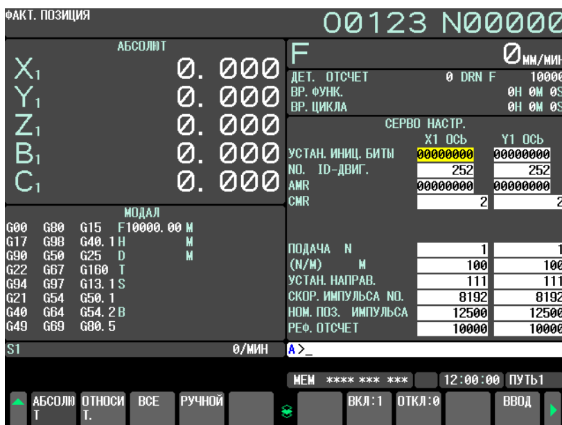
Рис. 12.4.10.7 (а) Окно настройки сервосистемы (дисплей 10.4 дюймов)
