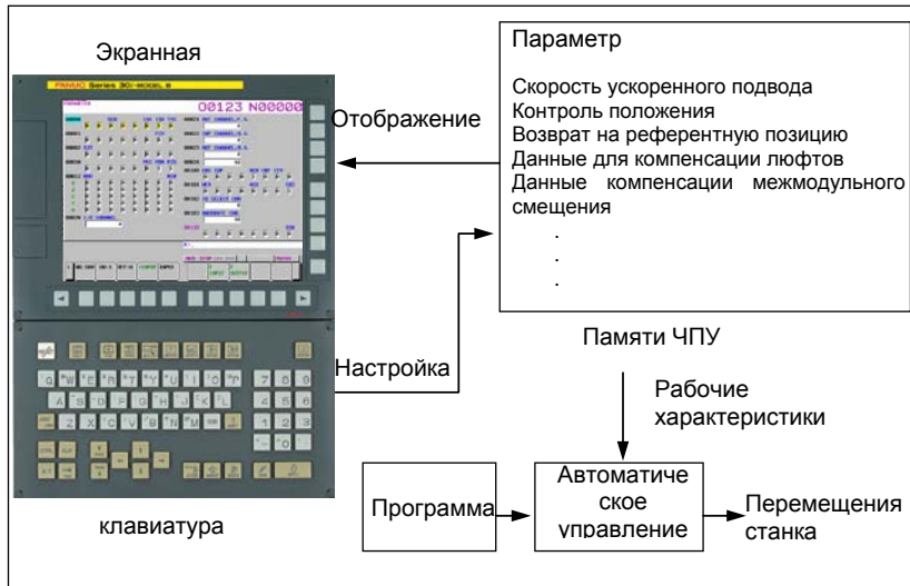
Рис. 1.6 (е) Отображение и настройка параметров
