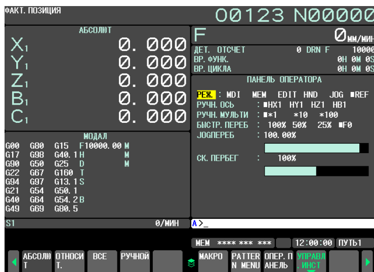
Рис. 12.3.8 (b) Страница 1 окна программной панели оператора (с функцией ручной подачи маховиком) (дисплей 10,4 дюйма)
