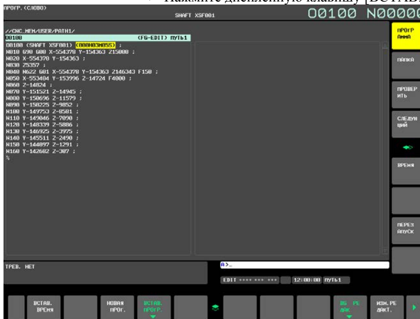
Рис. 12.2.17 (е) Окно программы (дисплей 15 дюймов)
