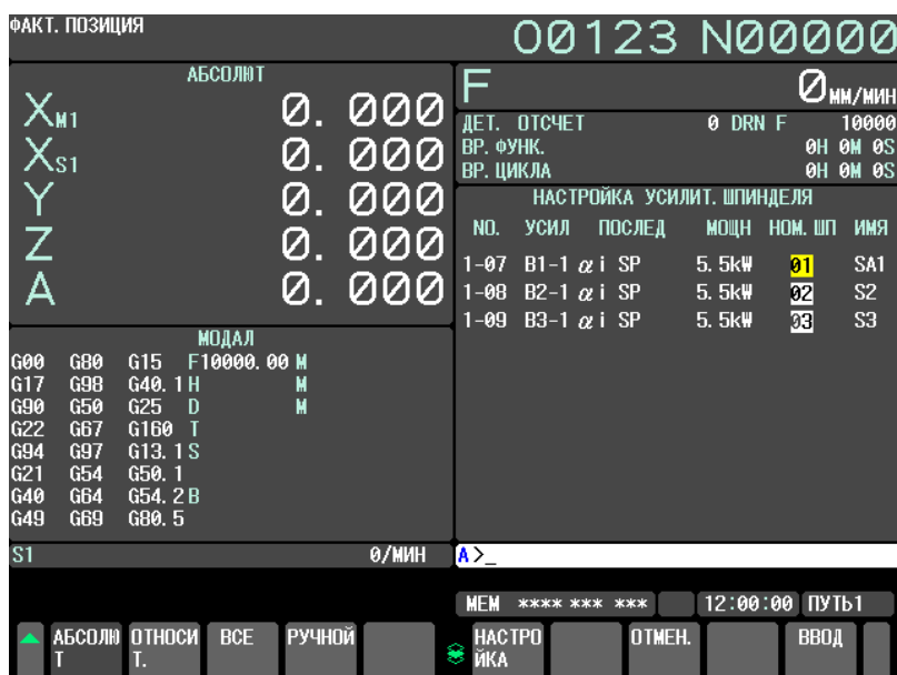
Рис. 12.4.10.5 (а) Окно настройки сервоусилителя шпинделя FSSB (дисплей 10.4 дюймов)
