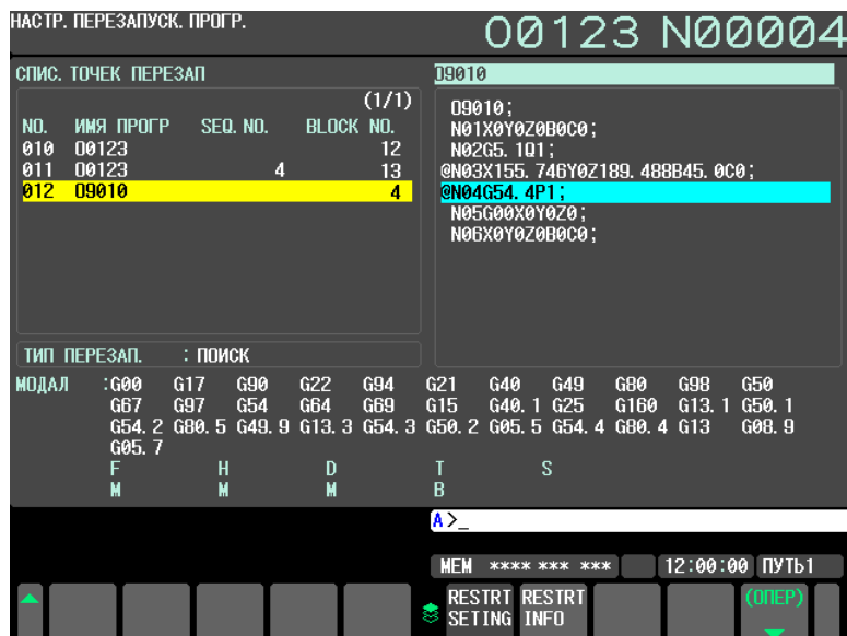
Рис. 4.10 (с) Окно установки перезапуска программы (перечень точек перезапуска)
