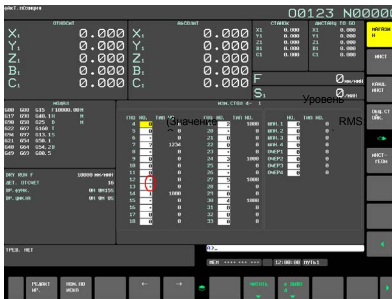
Рис. 12.3.27.5 (c) Таблица управления магазином (дисплей 15 дюймов)
