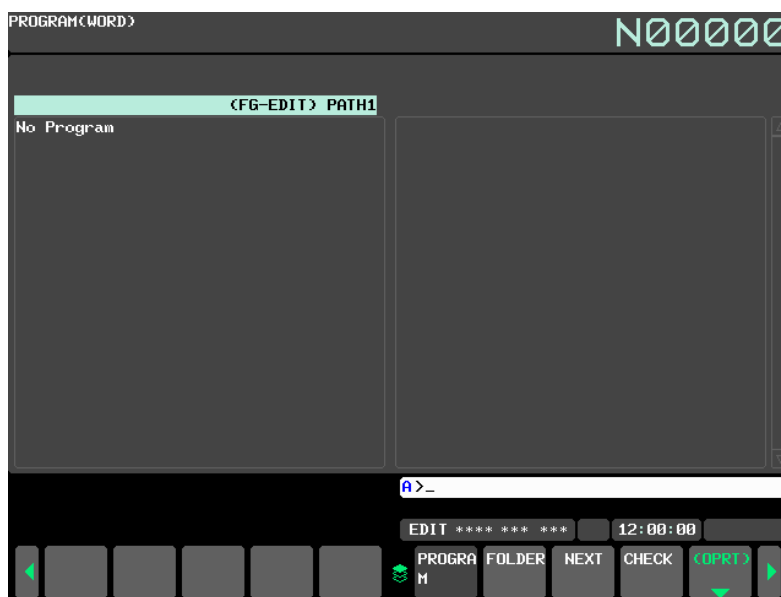
Рис. 9.4 (а) Окно программ (зарегистрированная программа отсутствует)
