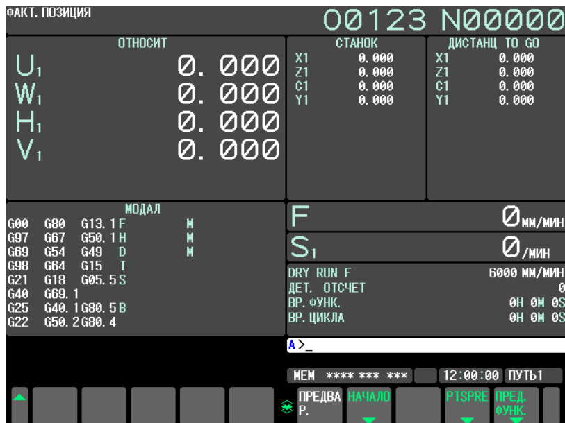
Рис. 12.1.2 (b) Окно текущей позиции (относительной) (серия T) (дисплей 10,4 дюйма)
