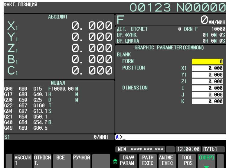
Рис. 13.2.1.1 (b) Окно ГРАФИЧЕСКИЕ ПАРАМЕТРЫ (вторая страница)
