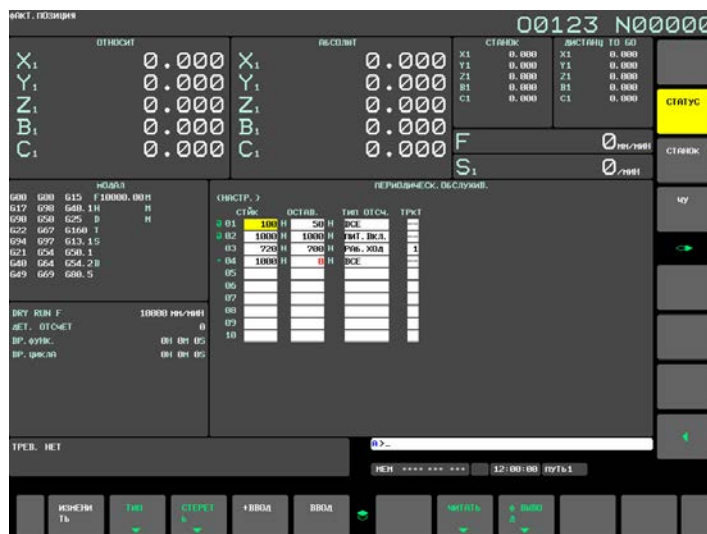
Рис. 12.4.24 (b) Окно настроек (дисплей 15 дюймов)
