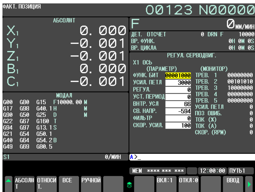
Рис. 12.4.10.10 (а) Окно настройки сервосистемы (дисплей 10.4 дюймов)
