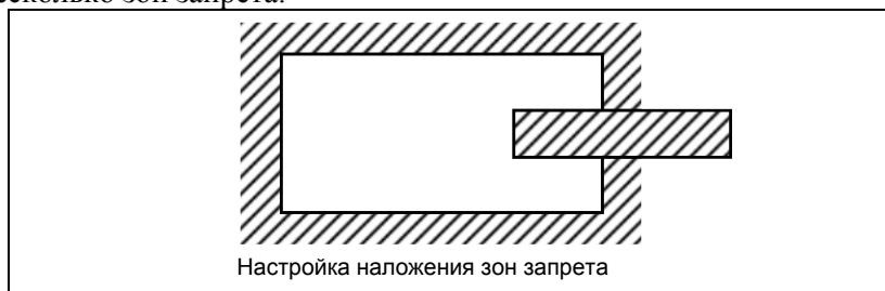
Рис. 6.3 (j) Настройка наложения зон запрета
