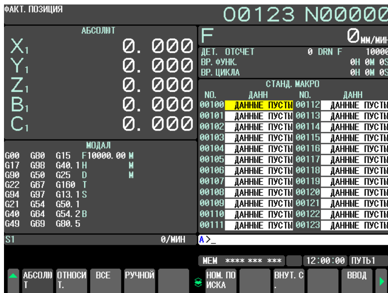
Рис. 12.3.6 (а) Окно CUSTOM MACRO (ПОЛЬЗОВАТЕЛЬСКАЯ МАКРОПРОГРАММА) (дисплей 10,4 дюйма)
