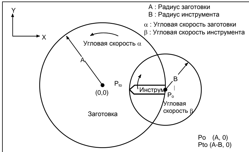
Рис. 21.2 (b) Принципы обточки многоугольника
