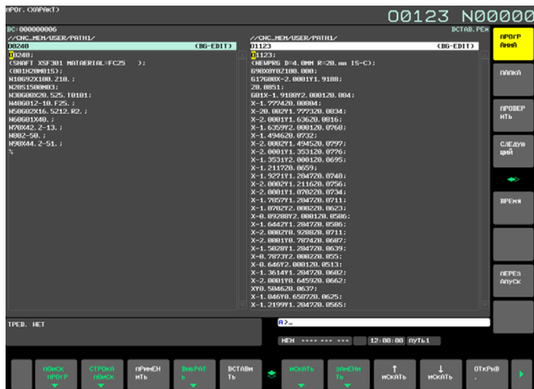
Рис. 12.2.16 (c) Окно фонового редактирования (редактирование символов) (дисплей 15 дюймов)
