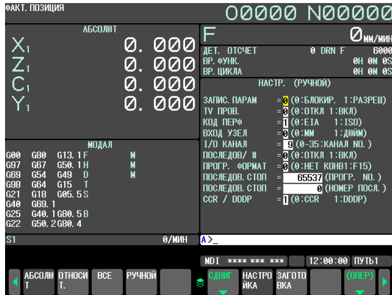
Рис. 12.3.1 (а) Окно НАСТРОЙКА (HANDY) (дисплей 10,4 дюймов)
