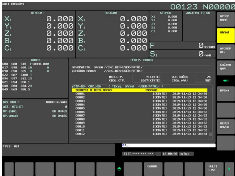
Рис. 12.2.13.1 (b) Нормальное окно папки программ (дисплей 15 дюймов)
