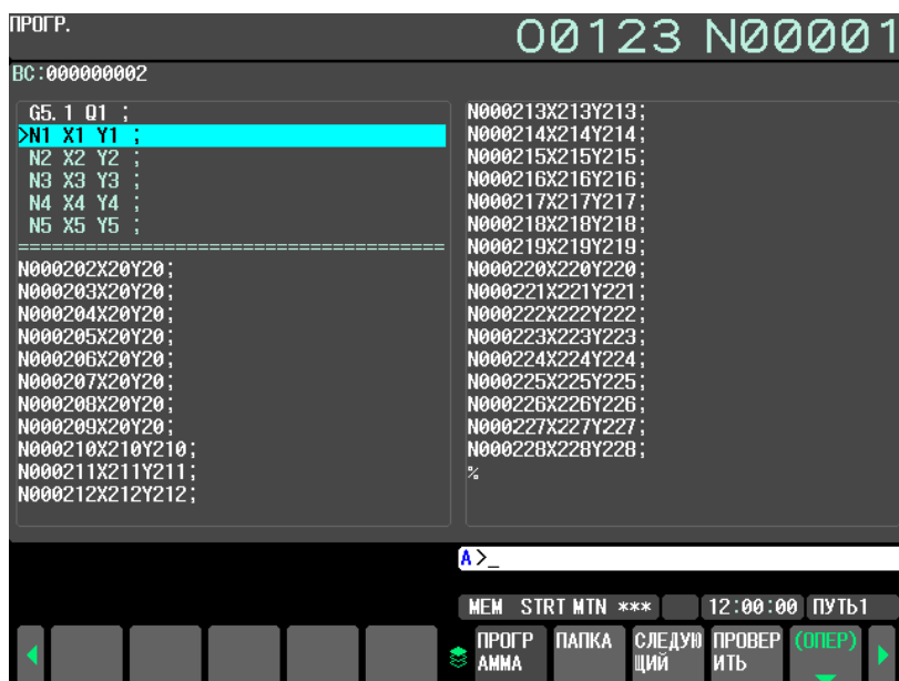
Рис. 12.2.1.1 (b) Окно для отображения выполняемой программы (режим MEM)
