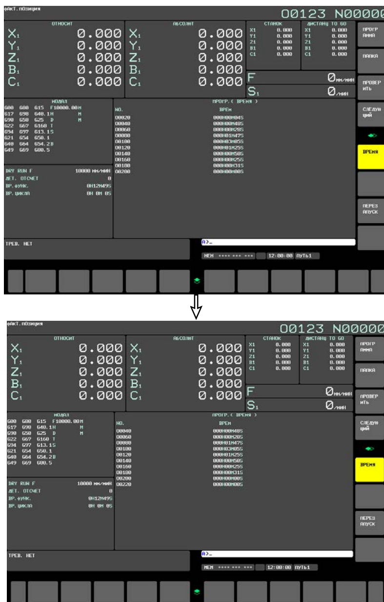
Рис. 12.2.17 (с) Указание времени обработки (дисплей 15 дюймов)
