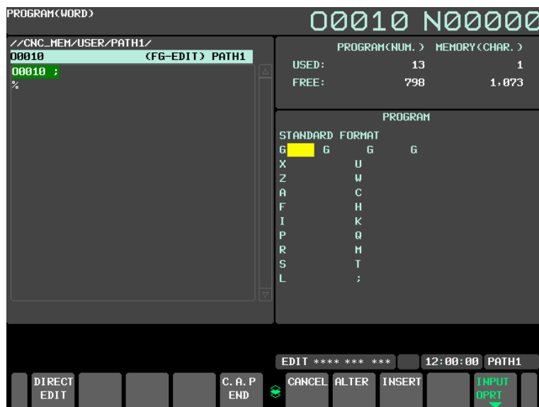
Рис. 9.4 (e) Окно данных G-кода (окно стандартных данных)
