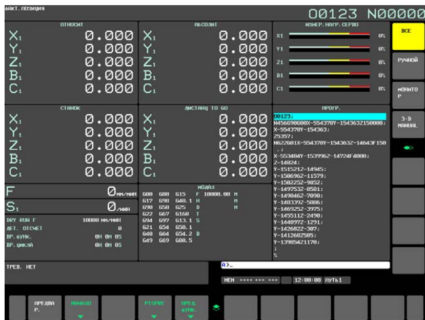
Рис. 12.1.9 (а) Окно отображения текущей позиции (полной) (серия М) (дисплей 15 дюймов)
