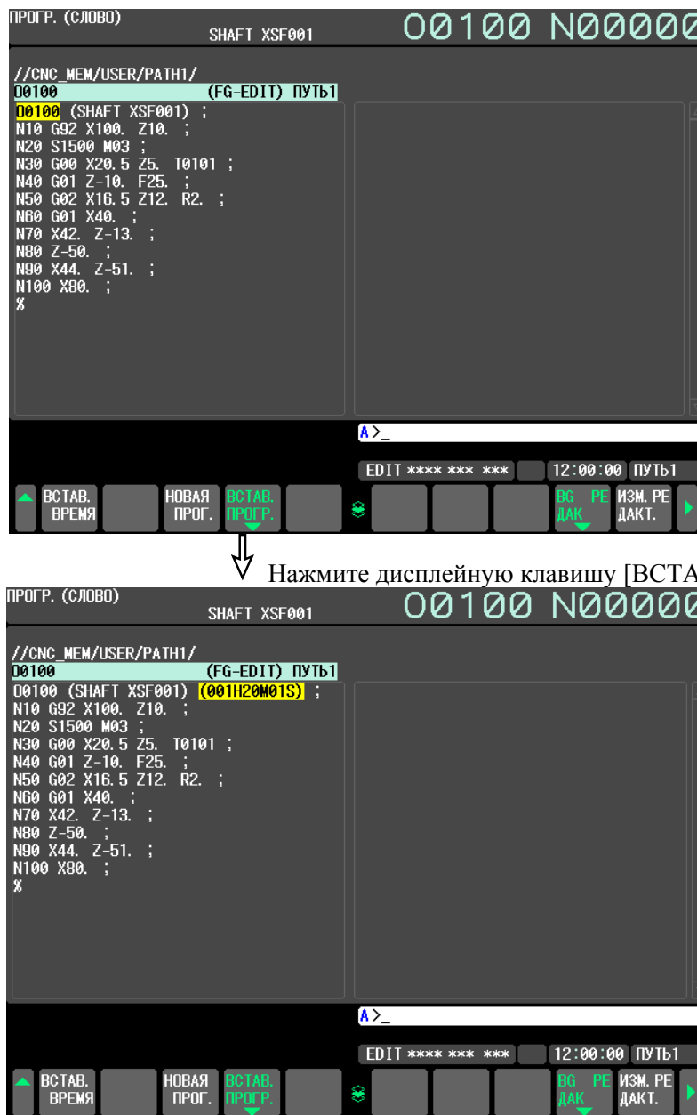
Рис. 12.2.8 (е) Окно программы (дисплей 10.4 дюймов)
