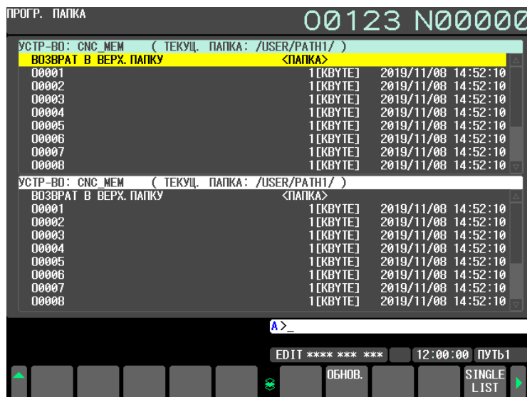
Рис. 12.2.4.1 (с)Окно папки программ (разделенное отображение) (дисплей 10.4 дюймов)
