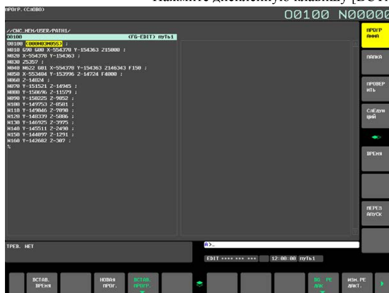
Рис. 12.2.17 (d) Окно программы (дисплей 15 дюймов)
