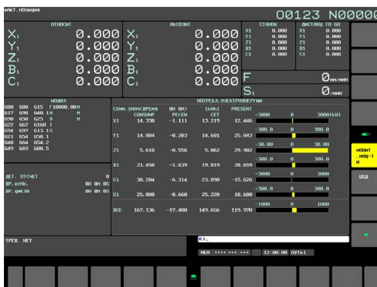
Рис. 12.4.26 (а) Окно мониторинга энергопотребления (дисплей 15 дюймов)
