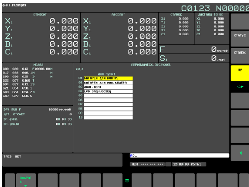
Рис. 12.4.24 (d) Окно меню ЧПУ (дисплей 15 дюймов)
