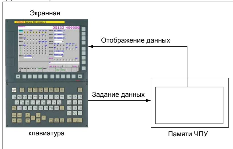
Рис.1.6 (а) Отображение и настройка данных
