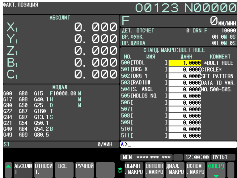
Рис. 19.2 (d) Экран пользовательской макропрограммы (бит 0 (РОС) параметра № 11318=0) (дисплей 10,4 дюйма)
