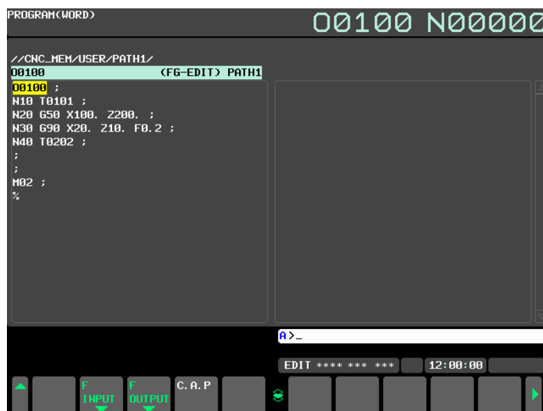
Рис. 9.4 (b) Окно программ (с зарегистрированной программой)
