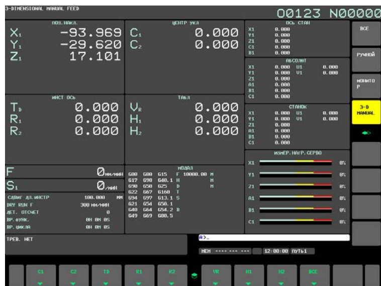
Рис. 12.1.14 (а) Окно трехмерной ручной подачи (дисплей 15 дюймов)
