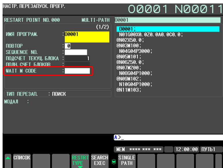
Рис.4.10.3 (а) Экран задания М-кода ожидания
