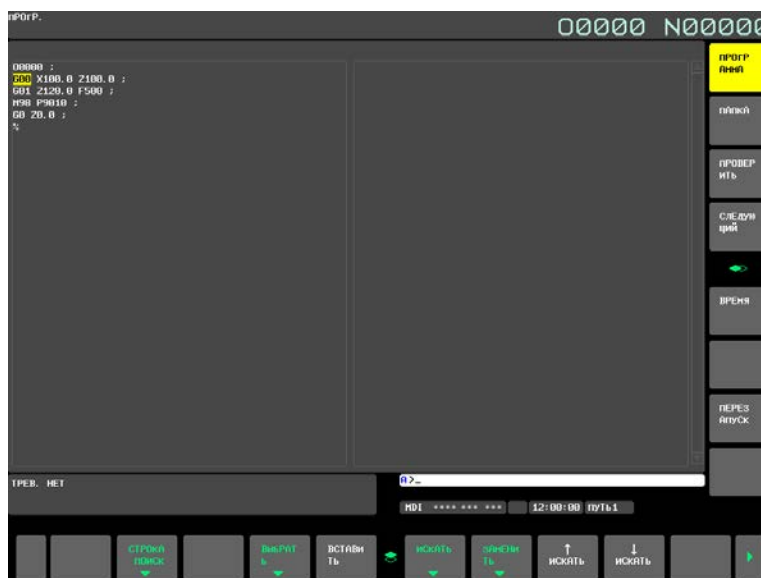
Рис. 12.2.12 (а) Окно программы для работы в режиме MDI (дисплей 15 дюймов)
