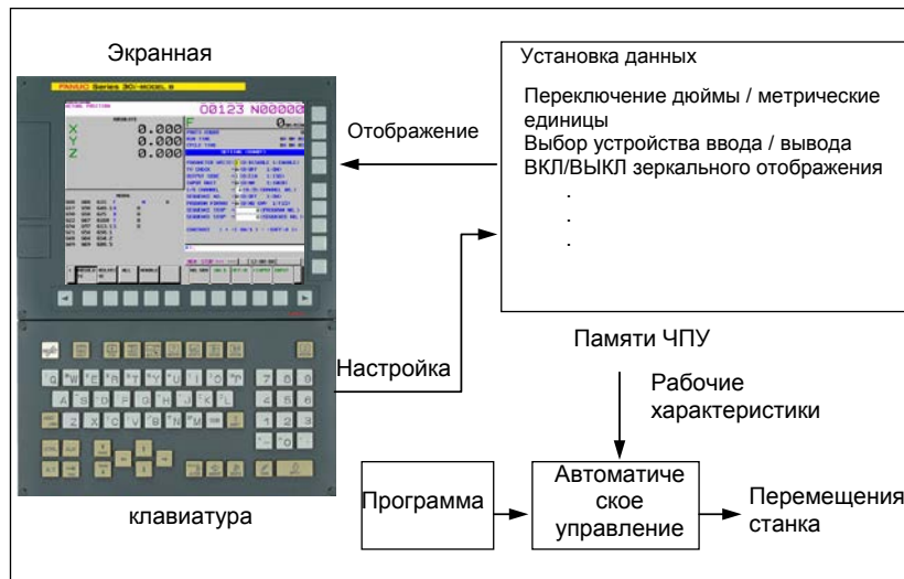
Рис. 1.6 (d) Отображение и настройка данных, задаваемых оператором
