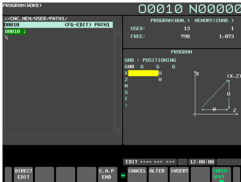
Рис. 9.4 (d) Окно подробных данных G-кода (G00)
