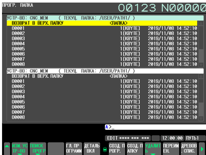
Рис. 12.2.4.1 (а) Окно папки программ (разделенное отображение) (дисплей 10.4 дюймов)
