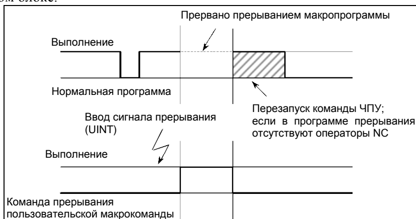
Рис. 16.17.2 (а) Прерывание пользовательской макропрограммы и команда NC (тип I)
