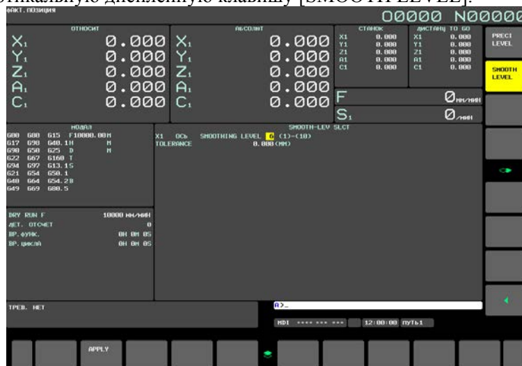
Рис. 12.3.31.1 (b) Окно выбора уровня чистоты обработки
