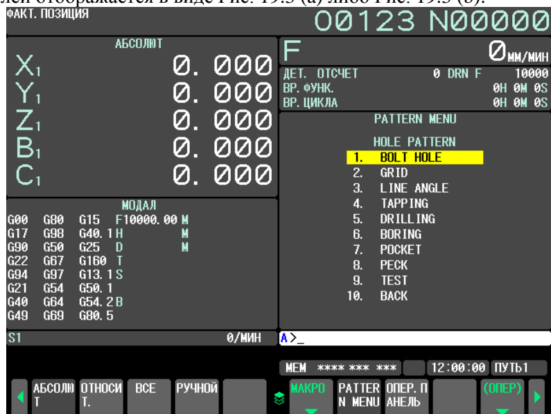
Рис. 19.3 (а) Экран меню моделей (устройство экрана 10.4 дюймов)
