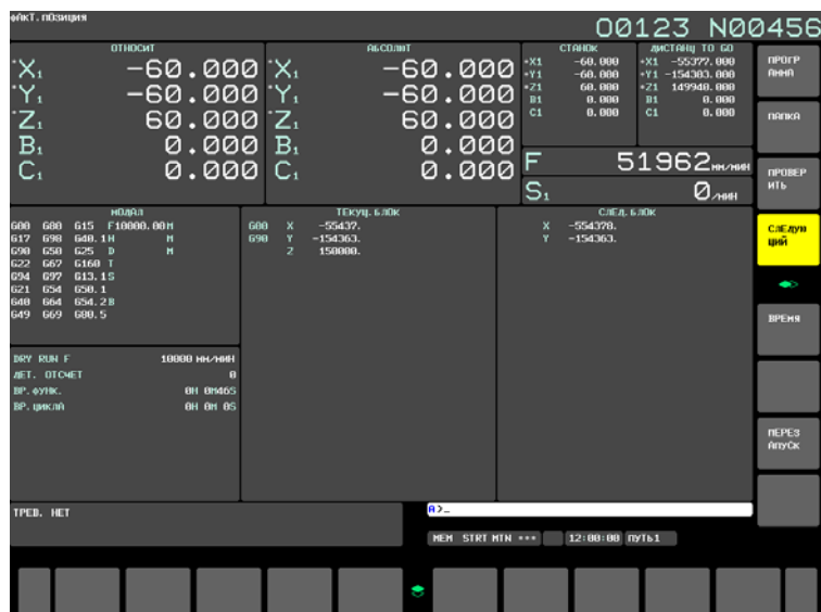
Рис. 12.2.14 (а) Окно отображения следующего блока (дисплей 15 дюймов)
