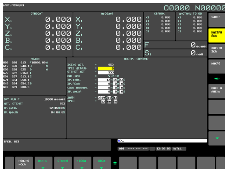
Рис. 12.3.21 (а) Окно НАСТРОЙКА (TIMER) (дисплей 15 дюймов)
