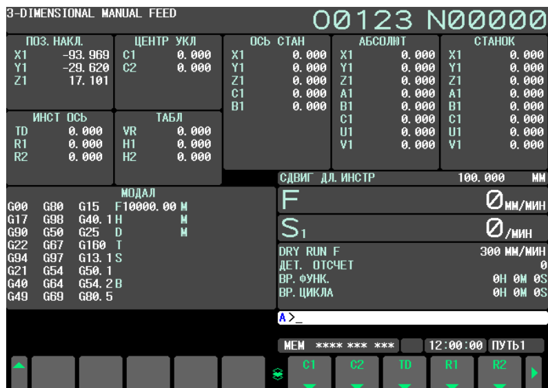
Рис. 12.1.8 (а) Окно трехмерной ручной подачи (дисплей 10.4 дюймов)
