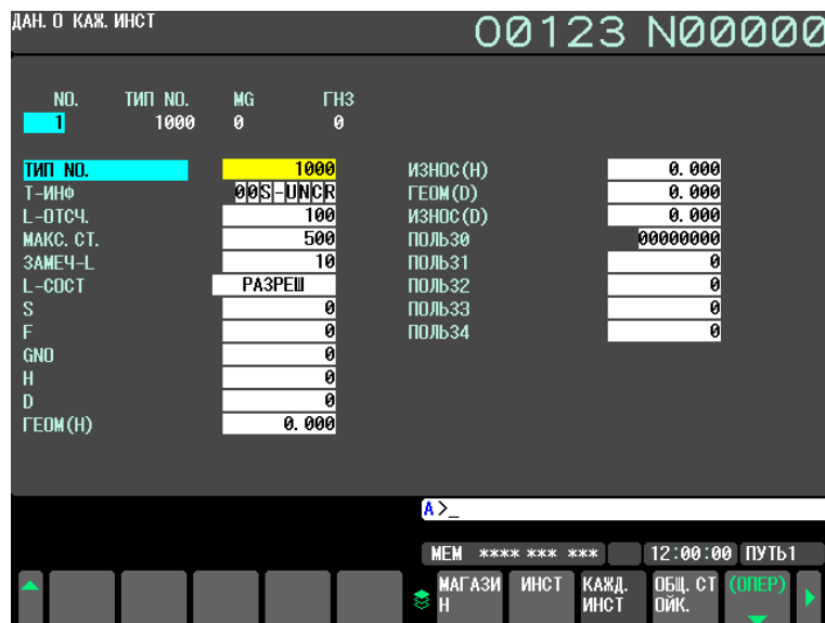
Рис. 12.3.9.3 (а) Окно данных отдельных инструментов (дисплей 10,4 дюймов)
