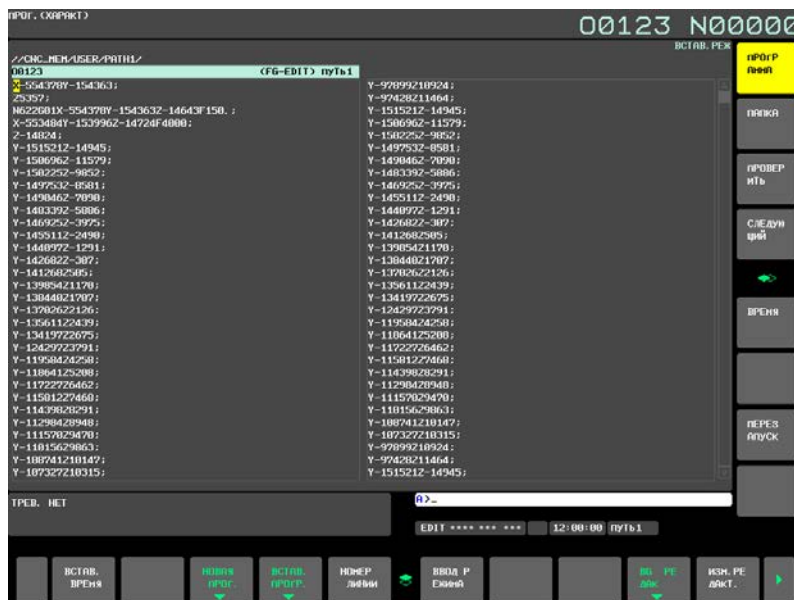
Рис. 12.2.11 (б) Окно редактирования символов программы (дисплей 15 дюймов)
