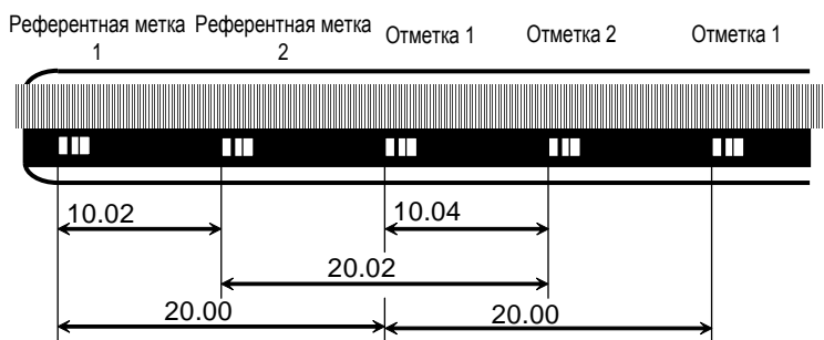
Рис. 3.9 Пример линейной шкалы с кодировкой по расстоянию
