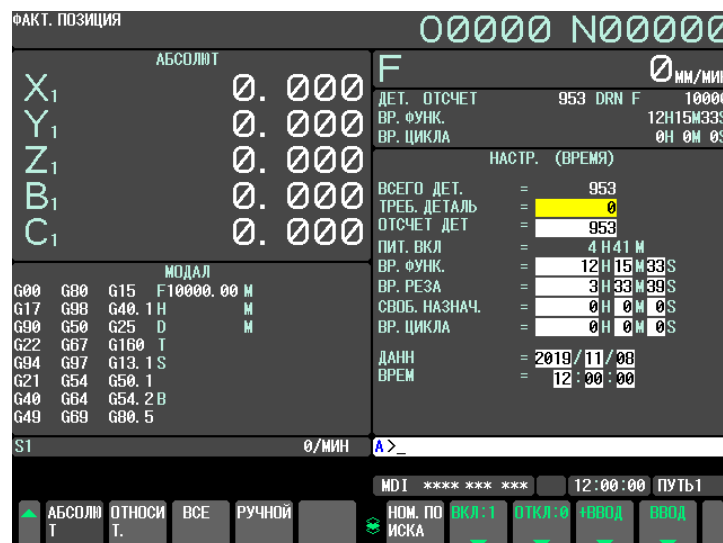
Рис. 12.3.3 (а) Окно НАСТРОЙКА (TIMER) (дисплей 10,4 дюйма)
