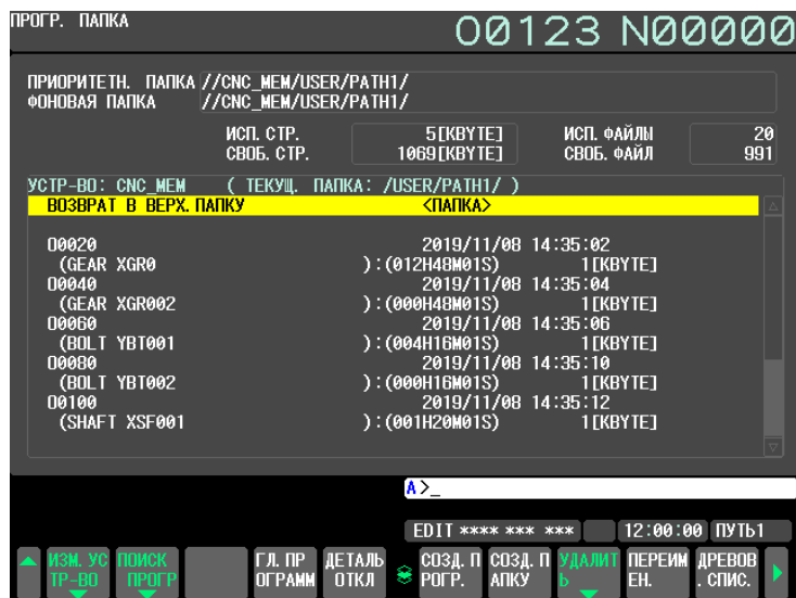
Рис. 12.2.8 (f) Окно папки программ (дисплей 10.4 дюймов)
