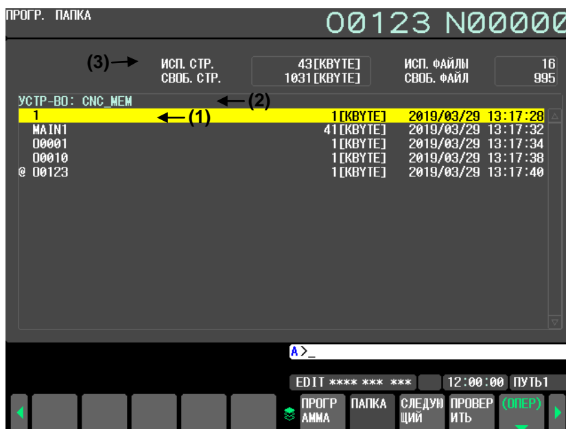
Рис. 11.14.2 (b) Экран папки программ (параметр CFP ном. 11304#7)=1)
