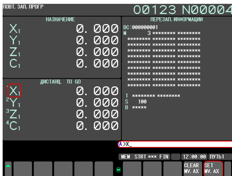
Рис. 4.9 (ф) Окно перезапуска программы (настройка перемещения осей)
