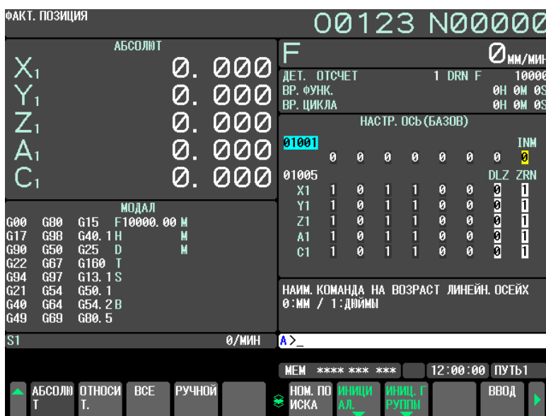
Рис. 12.4.10.1 (b) Окно настройки оси (дисплей 10.4 дюймов)
