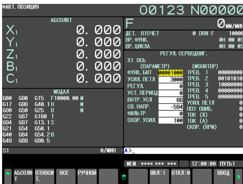
Рис. 12.4.3 (а) Окно настройки параметров сервосистемы (дисплей 10,4 дюйма)
