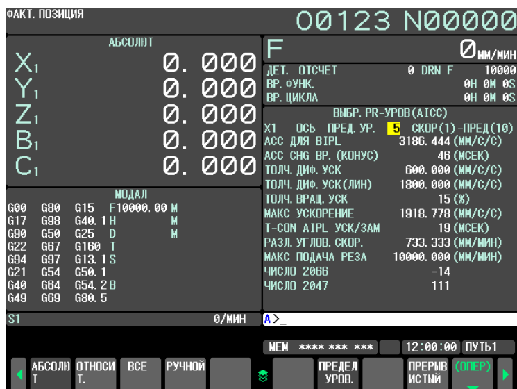
Рис. 12.3.12 (b) Окно выбора уровня точности (дисплей 10,4 дюйма)
