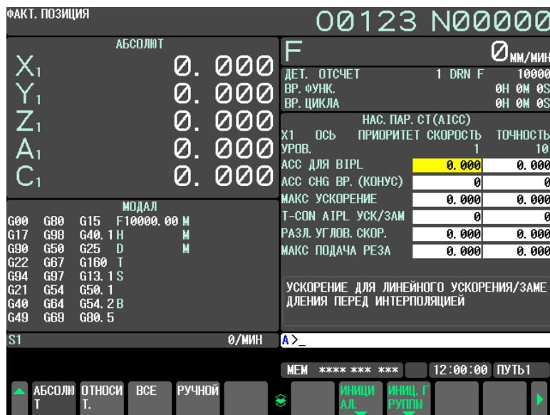
Рис. 12.4.10.12 (а) Окно настройки параметров обработки (дисплей 10.4 дюймов)
