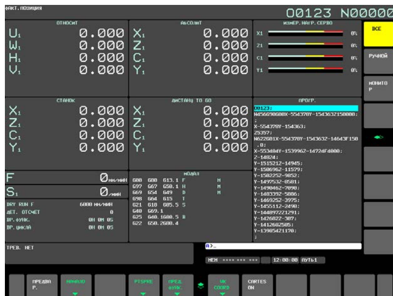
Рис. 12.1.9 (б) Окно отображения текущей позиции (полной) (серия Т) (дисплей 15 дюймов)
