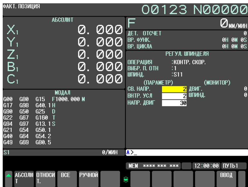
Рис. 12.4.10.11 (а) Окно настройки шпинделя (дисплей 10.4 дюймов)
