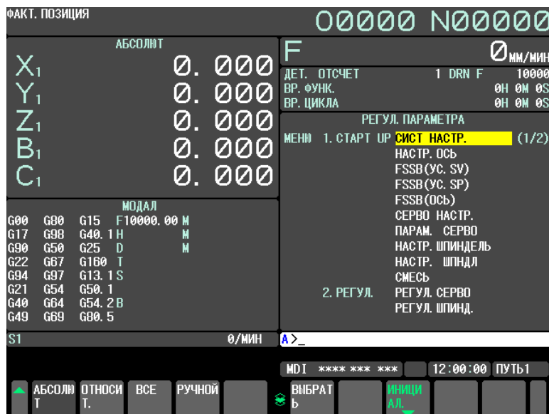
Рис. 12.4.10.1 (а) Окно меню настройки параметров (дисплей 10,4 дюйма)
