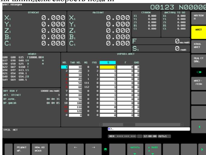
Рис. 12.3.27.2 (d) Окно скорости шпинделя / скорости подачи в данных управления инструментом (дисплей 15 дюймов)
