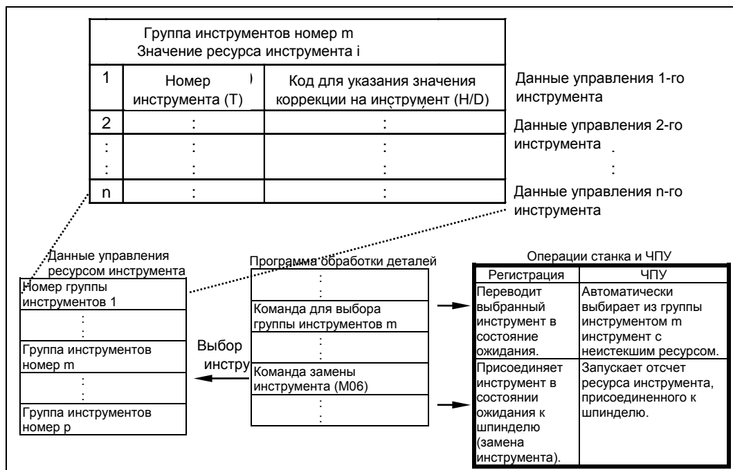
Рис. 10.5 (а) Выбор инструмента из программы обработки
