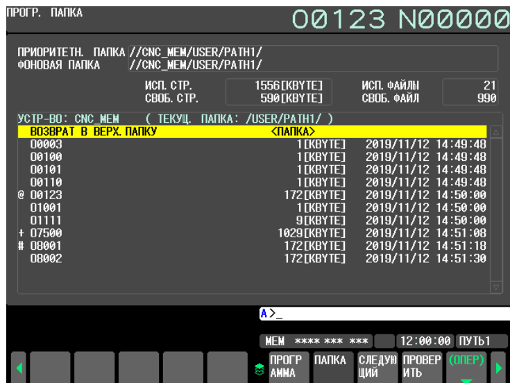
Рис. 13.2.1.2 (h) Окно списка программ (состояние выбора целевой программы)
