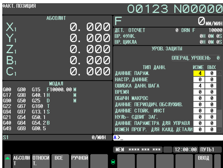
Рис. 12.3.11.3 (а) Окно изменения уровня защиты (дисплей 10,4 дюйма)
