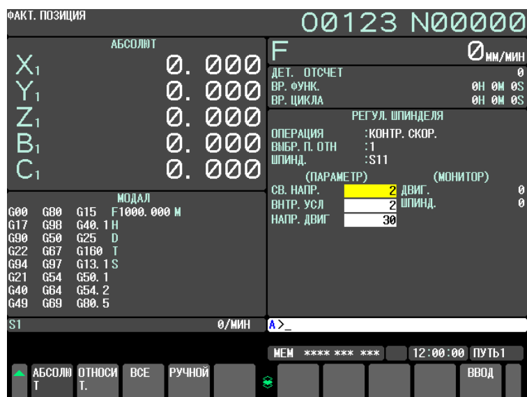
Рис. 12.4.5 (а)Окно настройки шпинделя (дисплей 10,4 дюйма)
