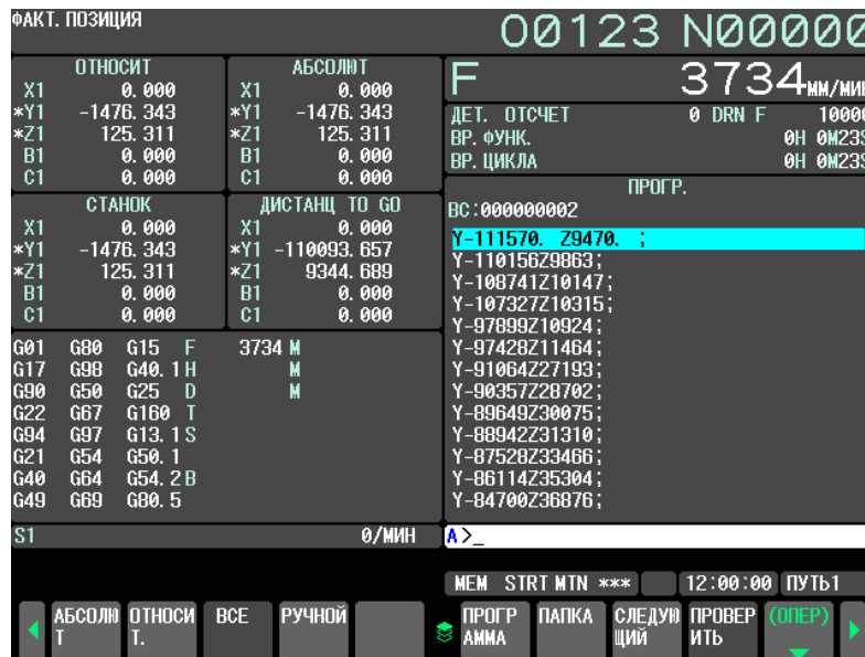
Рис. 4.3 (b) Окно PROGRAM CHECK (Проверка программы)
