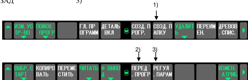
Рис.11.14.2 (с) Отображение дисплейных клавиш для устройства CNC_MEM
