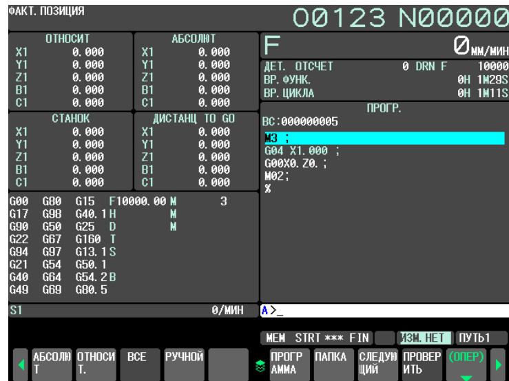
Рис. 5.7 (d) Дисплей состояния "ИЗМ.НЕТ."
