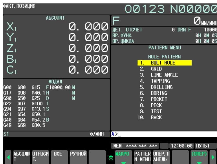
Рис. 12.3.15 (а) Окно меню модели (дисплей 10,4 дюйма)
