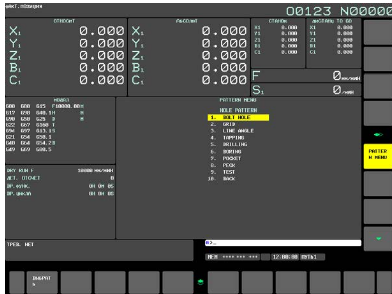
Рис. 19.3 (b) Экран меню моделей (устройство экрана 15 дюймов)
