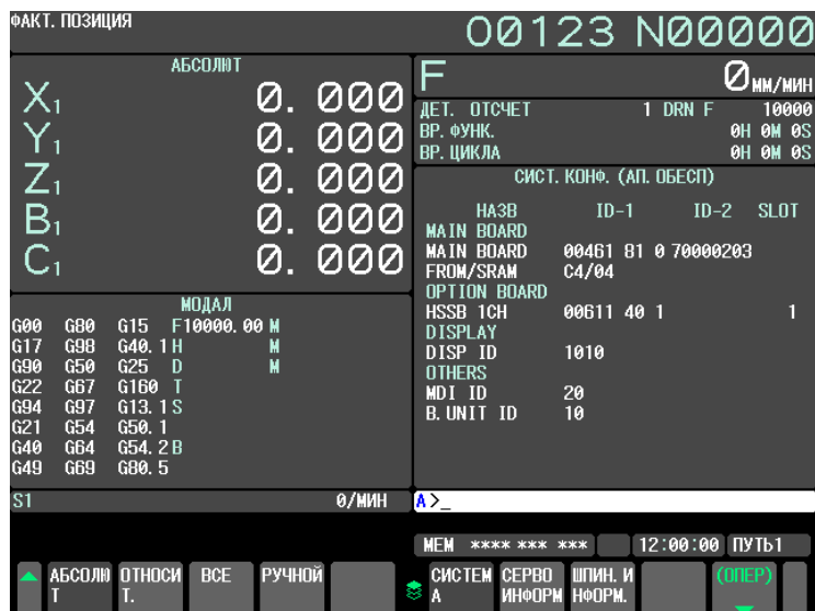
Рис. 12.4.12 (а) Окно конфигурации системы
