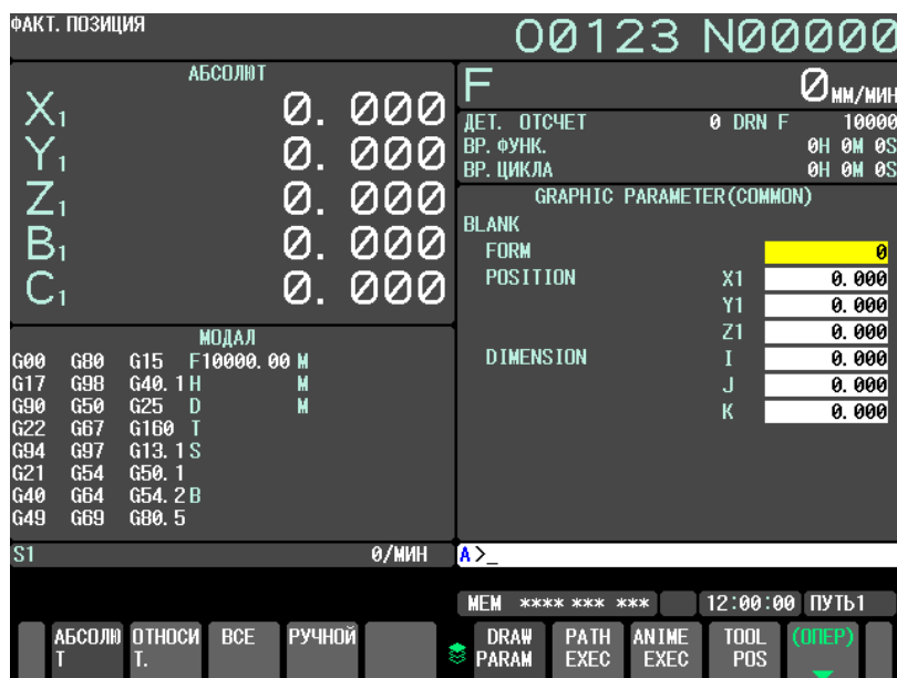
Рис. 13.2.2.1 (б) Окно ГРАФИЧЕСКИЕ ПАРАМЕТРЫ (вторая страница)
