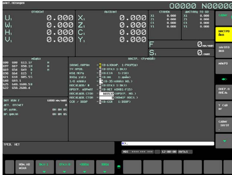
Рис. 12.3.19 (а) Окно НАСТРОЙКА (HANDY) (дисплей 15 дюймов)
