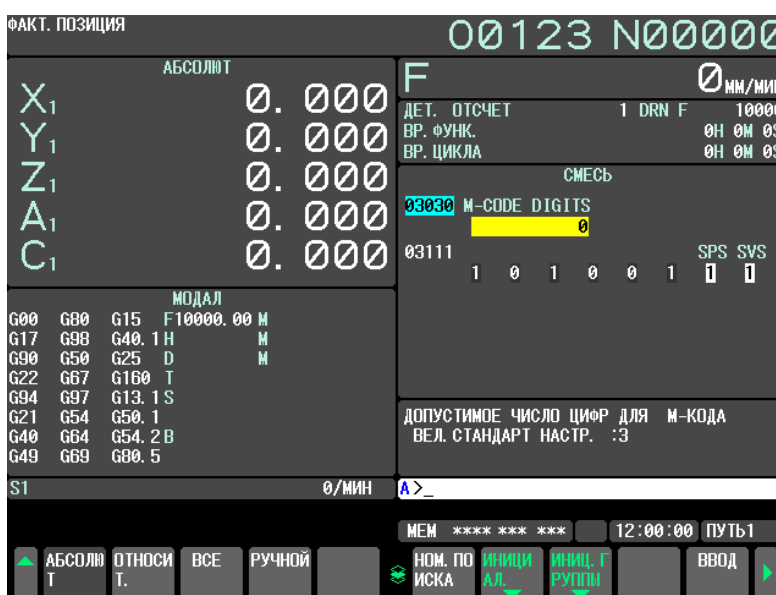
Рис. 12.4.10.9 (а) Окно настройки параметров (разные настройки) (дисплей 10.4 дюймов)
