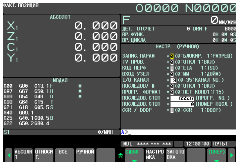
Рис. 12.3.2 (а) Окно НАСТРОЙКА (HANDY) (дисплей 10,4 дюймов)
