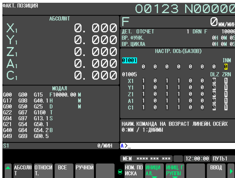
Рис. 12.4.10.3 (а) Окно настройки параметров (настройка оси) (дисплей 10.4 дюймов)
