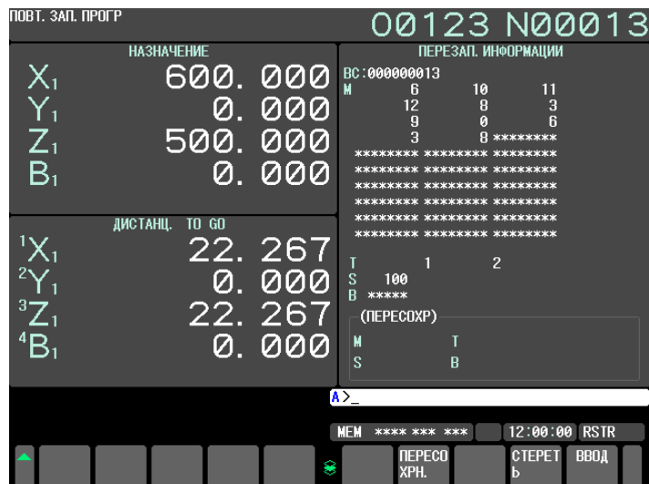
Рис. 4.9 (d) Окно перезапуска программы при выводе M-, S-, T- и B-кодов
