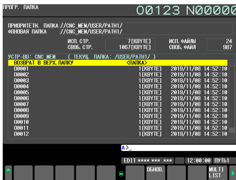
Рис. 12.2.4.1 (b) Окно папки программ (нормальное отображение) (дисплей 10.4 дюймов)
