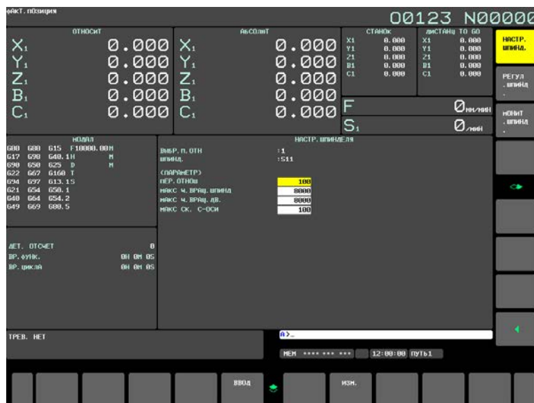
Рис. 12.4.17 (а) Окно настройки шпинделя (дисплей 15 дюймов)
