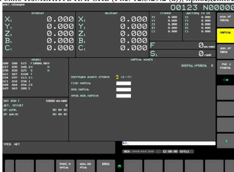
Рис. 12.3.29.2 (а) Окно ИЗМЕНИТЬ ПАРОЛЬ (дисплей 15 дюймов)
