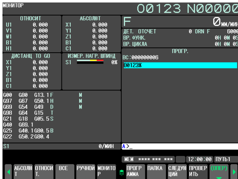
Рис. 12.9.1 (b) Индикатор нагрузки шпинделя
