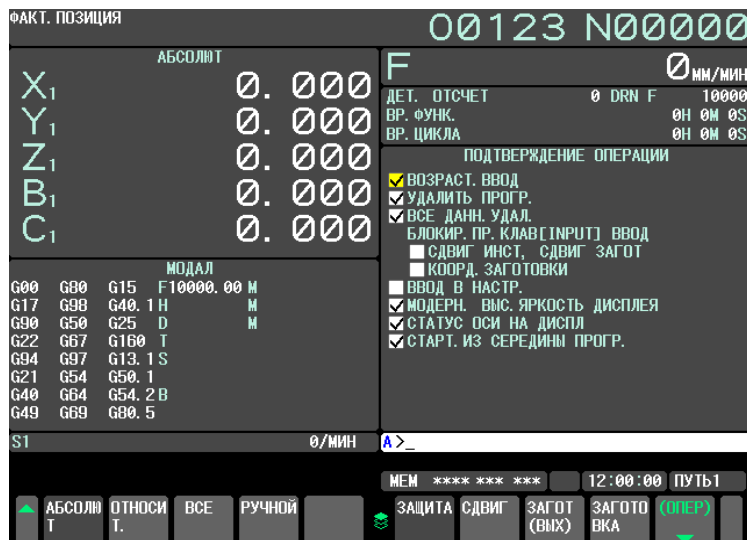
Рис. 6.7.3.1 Окно настройки функции подтверждения операции
