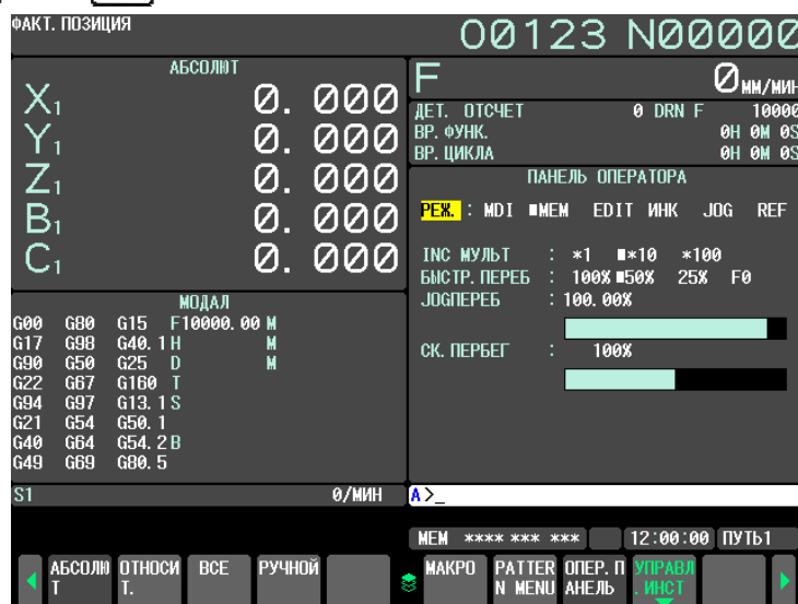
Рис. 12.3.8 (а) Страница 1 окна программной панели оператора (без функции ручной подачи маховиком) (дисплей 10,4 дюйма)
