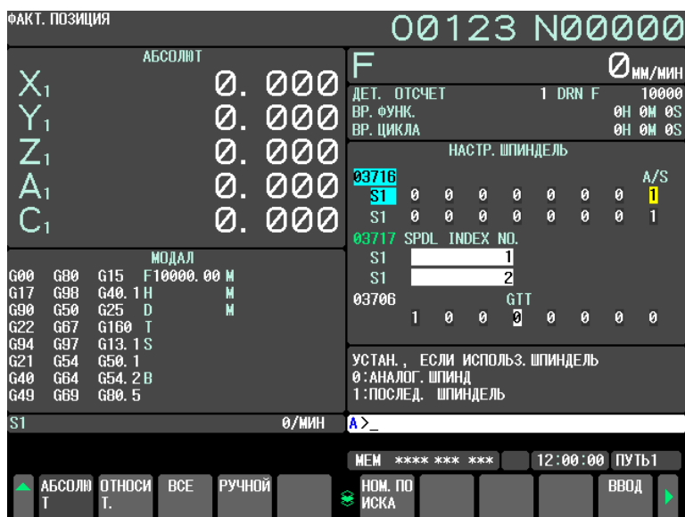
Рис. 12.4.10.8 (а) Окно настройки параметров (настройка шпинделя) (дисплей 10.4 дюймов)
