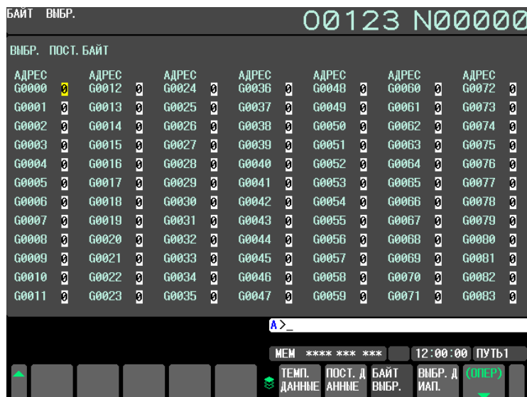
Рис. 12.3.7 (b) Окно ВЫБОР БАЙТА (дисплей 10,4 дюймов)
