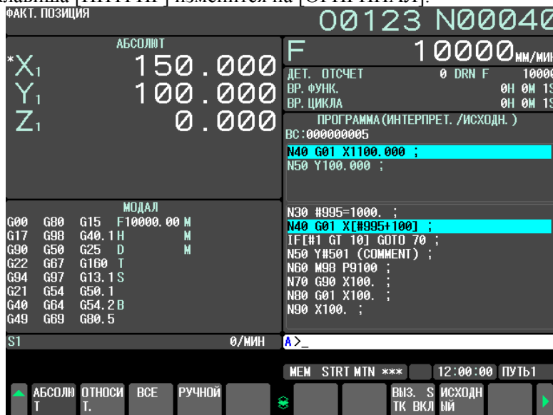
Рис. 12.2.1.4 (b) Окно проверки программы (10,4 дюйма) (Отображать интерпретированные и исходные программы в одном окне)
