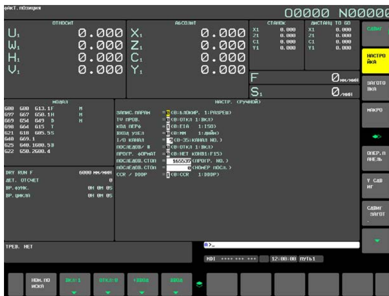
Рис. 12.4.14 (b) Окно НАСТРОЙКА (дисплей 15 дюймов)
