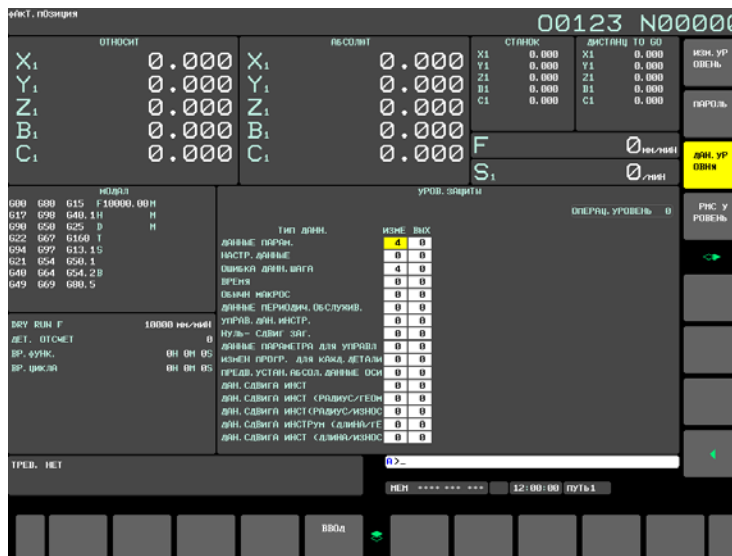
Рис. 12.3.29.3 (а) Окно ввода уровня доступа (дисплей 15 дюймов)
