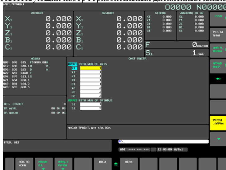
Рис. 12.4.23.2 (a) Окно настройки параметров (настройка системы) (дисплей 15 дюймов)
