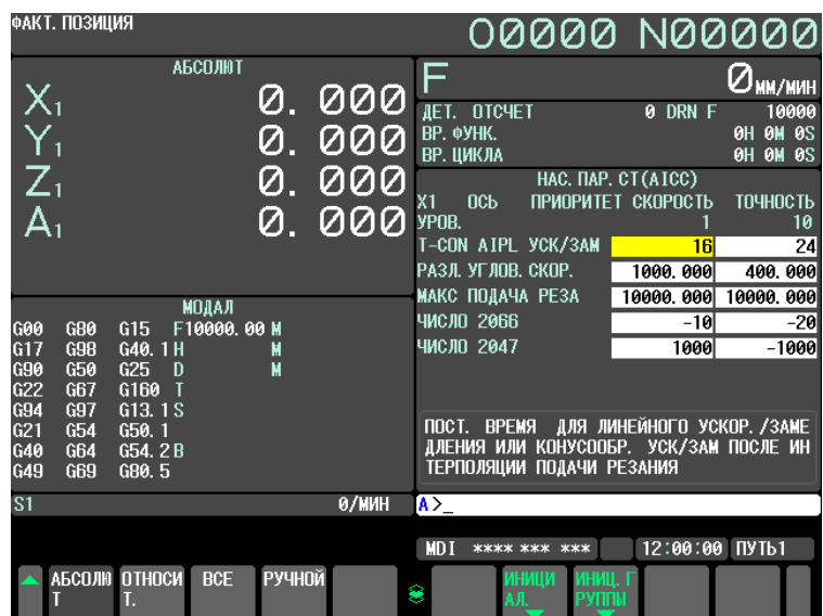
Рис. 12.4.8.1 (b) Окно настройки параметров обработки (контур А1) (дисплей 10.4 дюймов)
