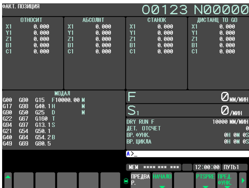
Рис. 12.1.3 (а) Окно текущей позиции (полной) (серия M) (дисплей 10,4 дюйма)
