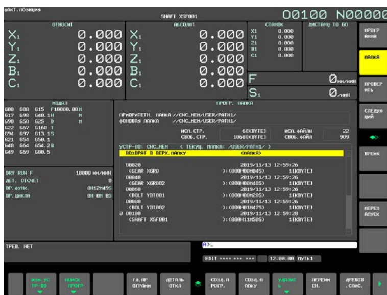
Рис. 12.2.17 (f) Окно папки программ (дисплей 15 дюймов)
