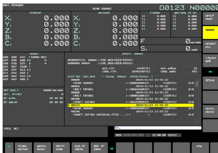
Рис. 12.3.29.4 (а) Окно папки программ (дисплей 15 дюймов)
