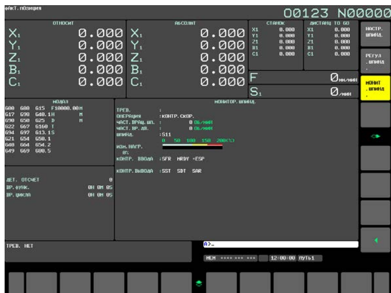
Рис. 12.4.19 (а) Окно монитора шпинделя (дисплей 15 дюймов)
