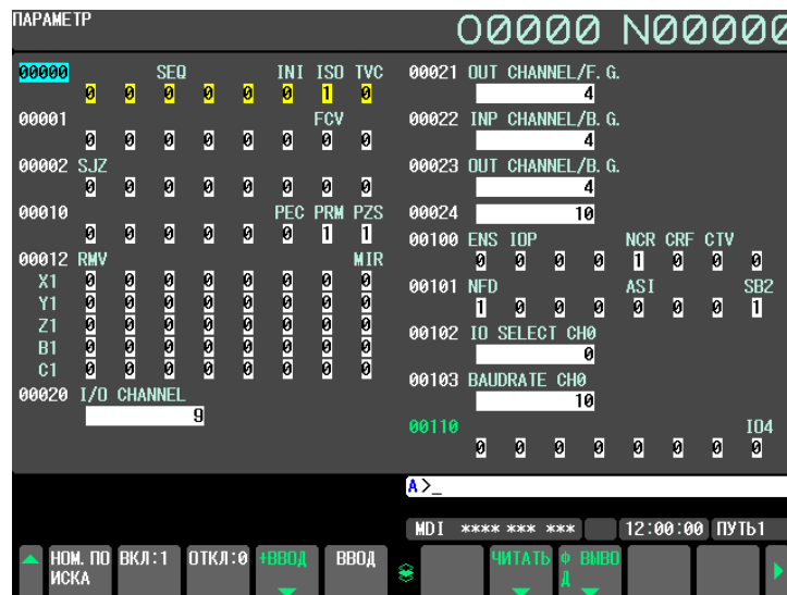
Рис. 12.4.1 (а) Окно PARAMETER (дисплей 10,4 дюйма)
