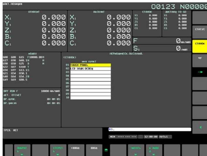
Рис. 12.4.24 (с) Окно меню станка (дисплей 15 дюймов)
