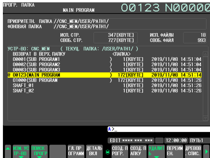
Рис. 12.3.11.4 (а) Окно папки программ (дисплей 10,4 дюймов)
