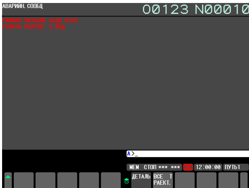
Рис. 7.1 (а) Информационный экран сигнала тревоги
