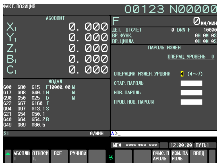
Рис. 12.3.11.2 (а) Окно ИЗМЕНИТЬ ПАРОЛЬ (дисплей 10,4 дюйма)
