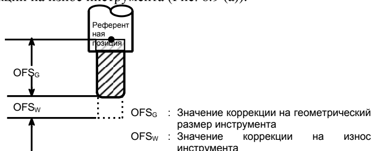
Рис. 6.9 (а) Коррекция на геометрические размеры инструмента и коррекция на износ инструмента
