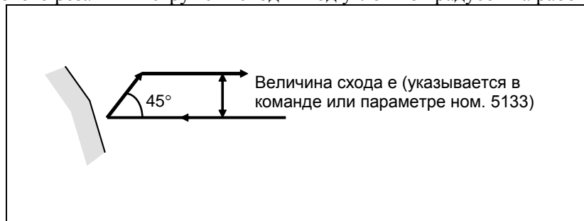
Рис. 4.2.1 (d) Резание под углом 45 градусов (тип I)
