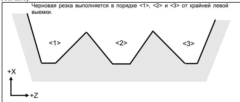
Рис. 6.4.1 (n) Порядок чернового резания в случае монотонного возрастания (тип II)
