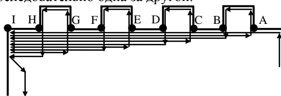
Рис. 4.2.1 (aa) Последовательные выемки (№ 5108#3=0)
