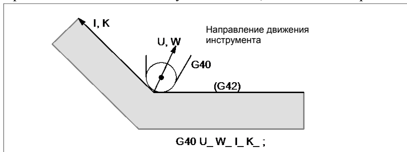
Рис. 5.2.4 (i) Если I и K заданы в одном блоке с G40
